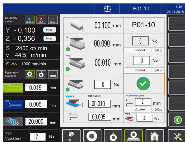
Informační obrazovka procesu broušení
